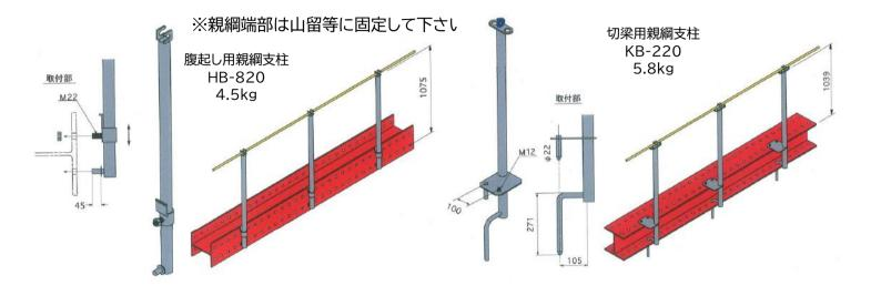
※H鋼 300m/m、350m/m、400m/m、450m/mに取付けができます。 その他のH鋼サイズについては、御相談ください。
